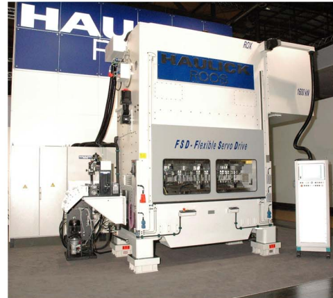
Abfederung eines 1.600-kN-Stanz- und Umformautomaten durch Federlager der KP-Baureihe von KTI.
