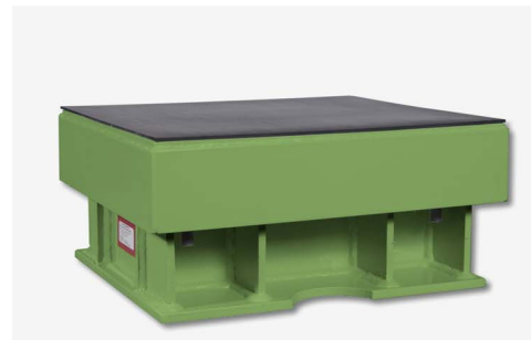
Federlager der KP-Baureihe von KTI mit integrierter viskoser Sicherheitsdämpfung, Tragfähigkeit 120 kN. Zum Schutz der Mitarbeiter sind die Stahlfedern mit Schutzblechen eingekleidet.
