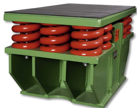
Federlager der PWG-Baureihe von KTI für die Unterflur-Anordnung mit integrierter viskoser Sicherheitsdämpfung und einer Tragfähigkeit von 2.500 kN.
