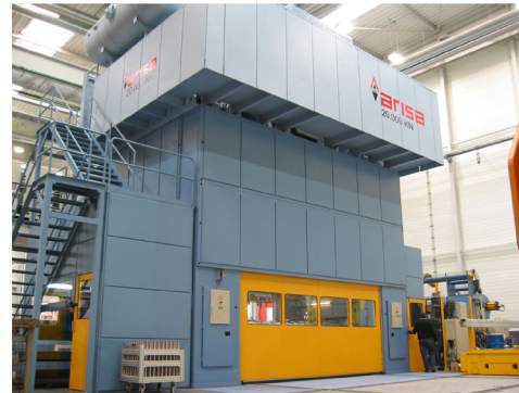
Vierpunkt-Transferpresse mit einer Presskraft von 20.000 kN.
