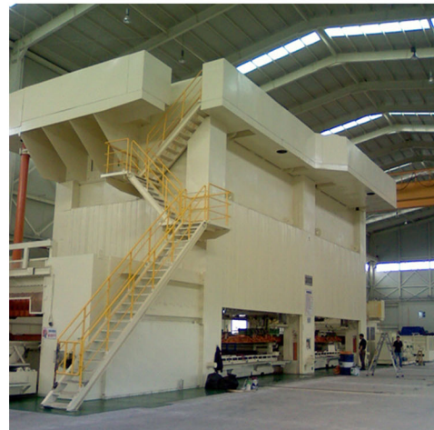
Mechanische Danly Transfer-Pressen mit 1.360 t Gesamtgewicht
