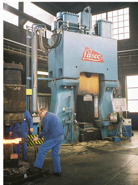
Perfekt gedämpft – größter hydraulischer Schmiedehammer der Schweiz
