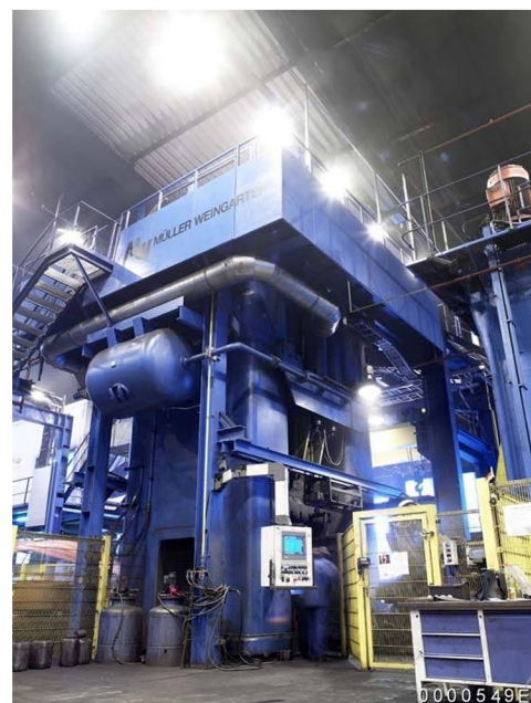
Optimale Dämpfung für Spindel- presse mit 1.020 to Gewicht
