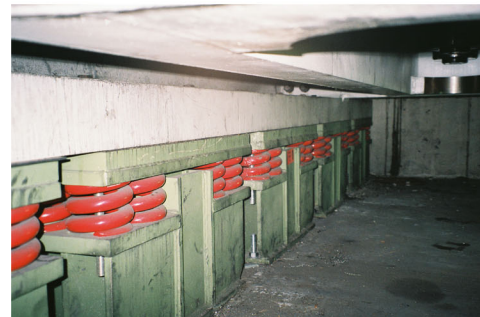
KTI Federlager für Immissionsschutz der größten Spindel- presse Deutschlands
