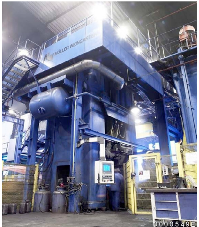
Optimale Dämpfung für eine Spindel­presse mit 1.020 t Gewicht
