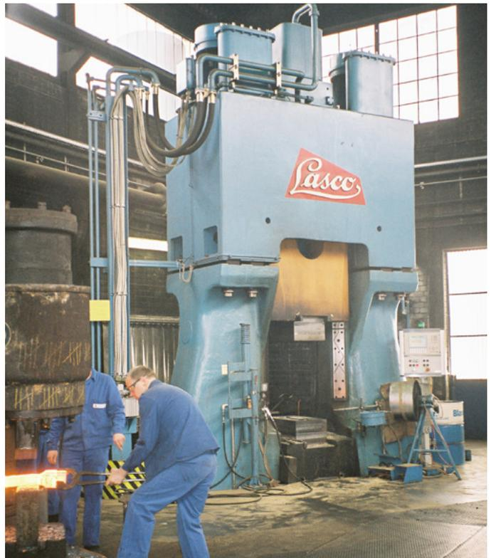
**Perfekt gedämpfter, hydraulischer Schmiedehammer**
