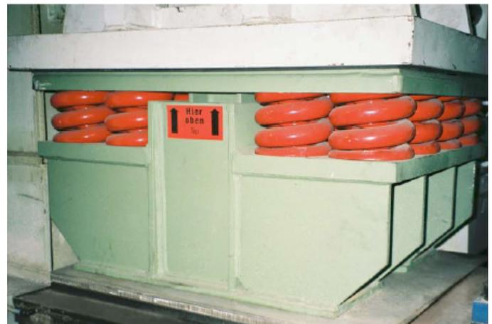
**KTI Federlager mit einer Tragfähigkeit von 1.600 kN**
