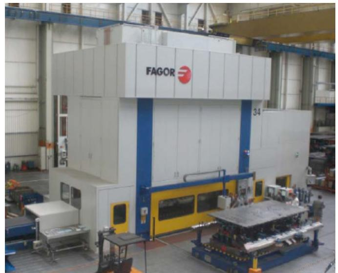
**FAGOR Transferpresse mit einer Presskraft von 20.000 kN**
