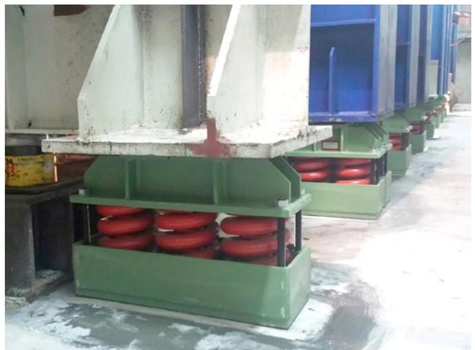
**Federlager zur Abfederung des Teststandes**
