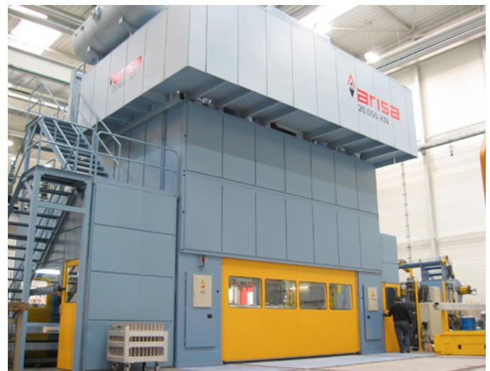
Vierpunkt-Transferpresse mit einer Presskraft von 20.000 kN
